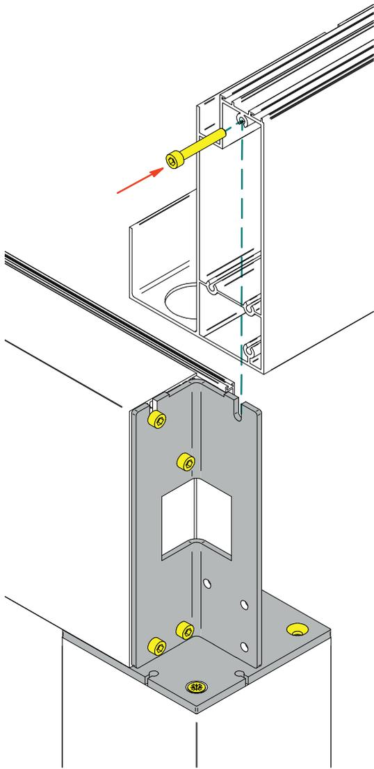
3.1 In den oberen Anschluss der Führungsschiene Schraube M6x40 einschrauben.
