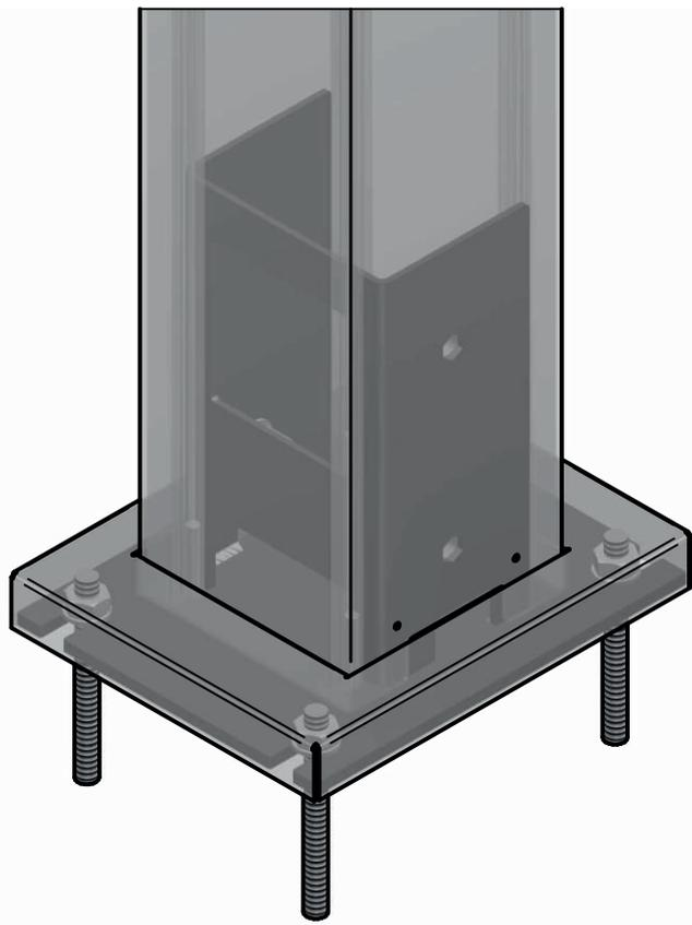
4.2 Nach dem Ankern mit chemischer Anker, befestigen Sie die Fußplatte und schieben Sie sie über die Pfostenabdeckung.
