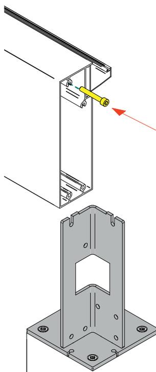
2.1 Vor dem Zusammenbau in der oberen Öffnung des Spannbalkens, schrauben eine M6x40-Schraube ein.
