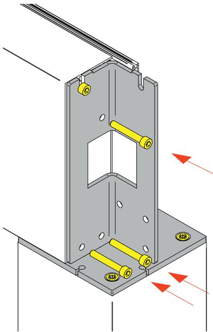
2.2 Nach dem Schieben des Spannbalkens in die Stutzpfosten, schrauben sie die restlichen M6x40 Schrauben ein.
