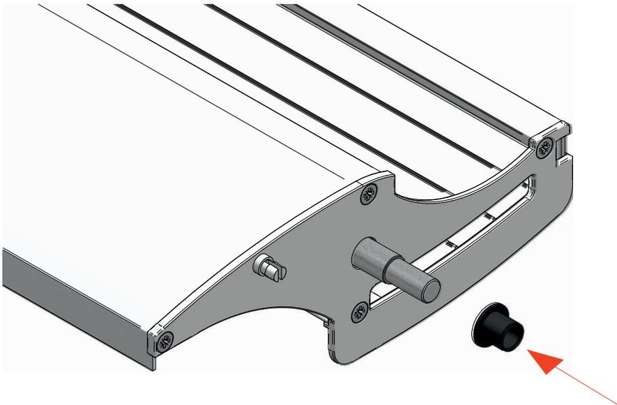
5.2 Setzen dann die Lamelle beidseitig in die Fräslöcher in der Führungsschiene ein.
