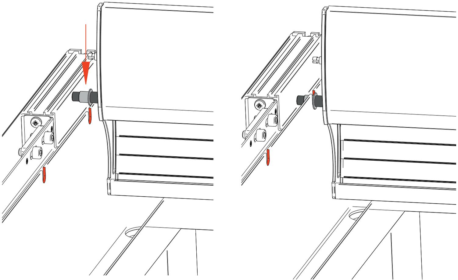
5.3 Jede Lamelle in der 90-V-Position muss mit dem Verbindungsprofil angeklickt werden
