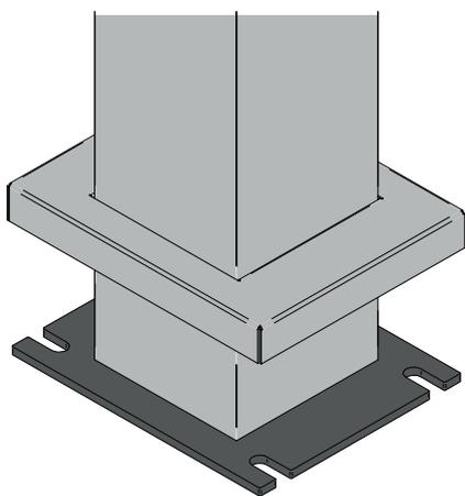
4.1 Um Konstruktion zu befestigen, muss die Pfostenabdeckung hoch angehoben werden und Bohrlöcher für die Schrauben zu sehen M10x100
