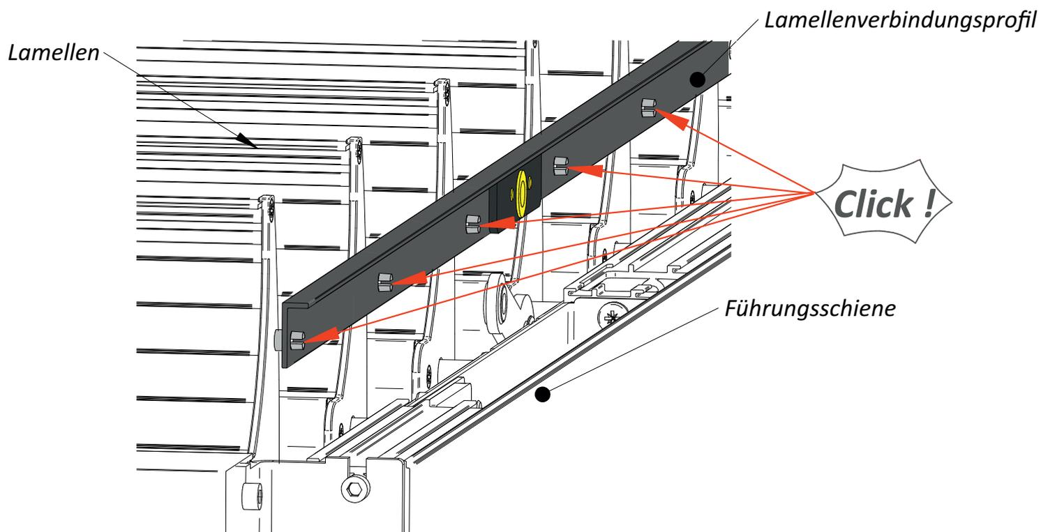
5.4 Nachdem alle Lamellen mit dem Verbindungsprofil angeklickt wurden, schrauben es mit den Motorarm mit Spezialschraube.
