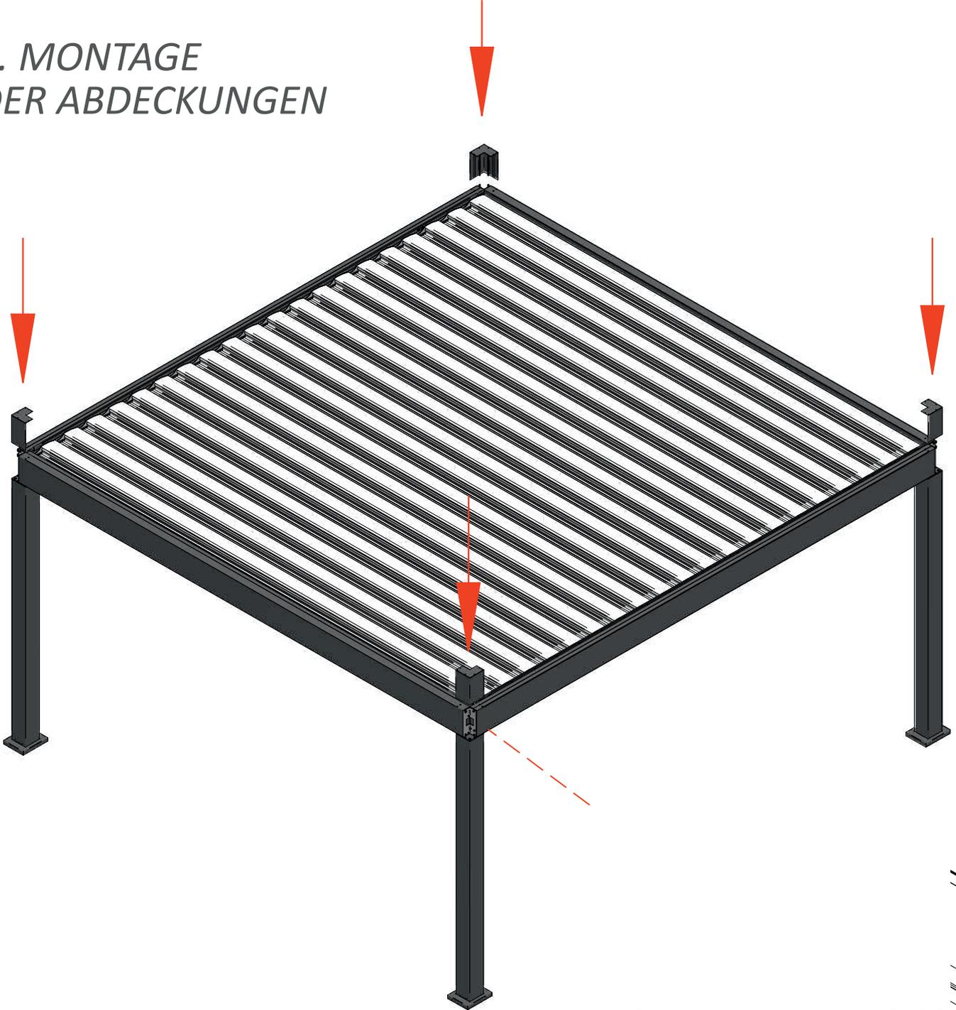
6.1 Stecken die Eckabdeckungen mit den Anschlüssen in die Stahlbuchsen und mit 4 Schrauben 3,5x16 anschrauben.
